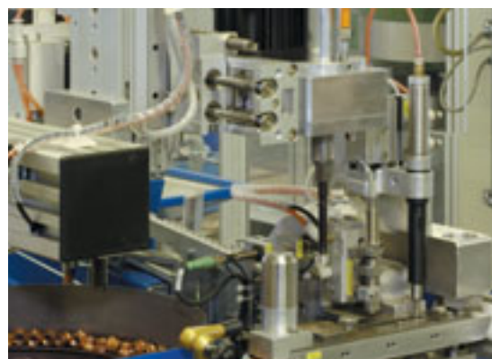
Automatické zpracování HELICOIL® plus M 8 SCREWLOCK®.
